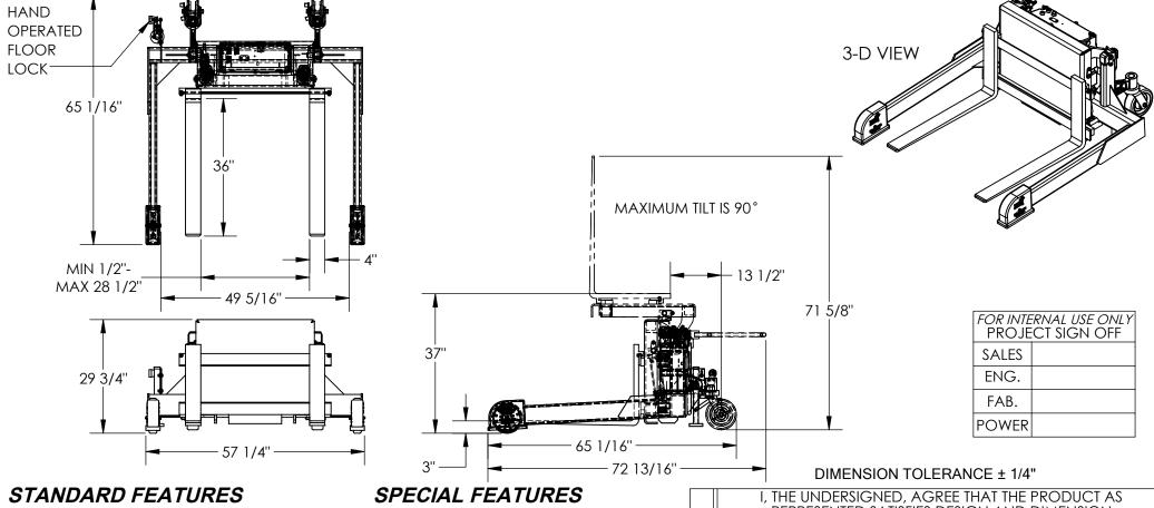
MODEL NUMBER IS TMS-20-DC CAPACITY IS 2,000 lbs FORK ADJUSTMENT IS 1/2" TO 28 1/2" I.D. OPERATOR REACH IS 13 1/2" STRADDLE I.D. IS 49 5/16" FORK WIDTH IS 4" USABLE FORK LENGTH IS 36" OVERALL WIDTH IS 57 1/4" OVERALL LENGTH IS 72 13/16" OVERALL HEIGHT IS 71 5/8" LOWERED FORK HEIGHT IS 3" **ROTATED HEIGHT IS 37"** LEVEL HEIGHT IS 29 3/4" INCLUDES HAND OPERATED FLOOR LOCK 12 VOLT DC POWERED CHARGER INDICATOR ON-BOARD BATTERY CHARGER (115V AC) DURABLE LIQUID PAINT BLUE FINISH
