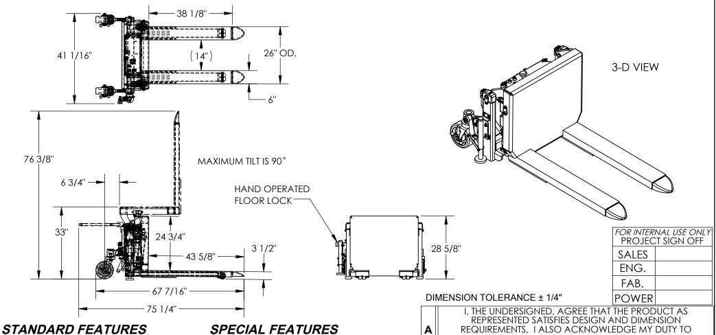
MODEL NUMBER IS TM-20-AC CAPACITY IS 2,000 lbs **OVERALL WIDTH IS 41 1/16"** OVERALL LENGTH IS 75 1/4" **OVERALL HEIGHT IS** 76 3/8" **ROTATED HEIGHT IS 33"** LEVEL HEIGHT IS 28 5/8" FORK WIDTH IS 6" LOWERED FORK HEIGHT IS 3 1/2" USABLE FORK LENGTH IS 38 1/8" FORK ADJUSTMENT FIXED AT 26" OD. INCLUDES FLOOR LOCK 115 VOLT AC POWERED DURABLE LIQUID PAINT BLUE FINISH
