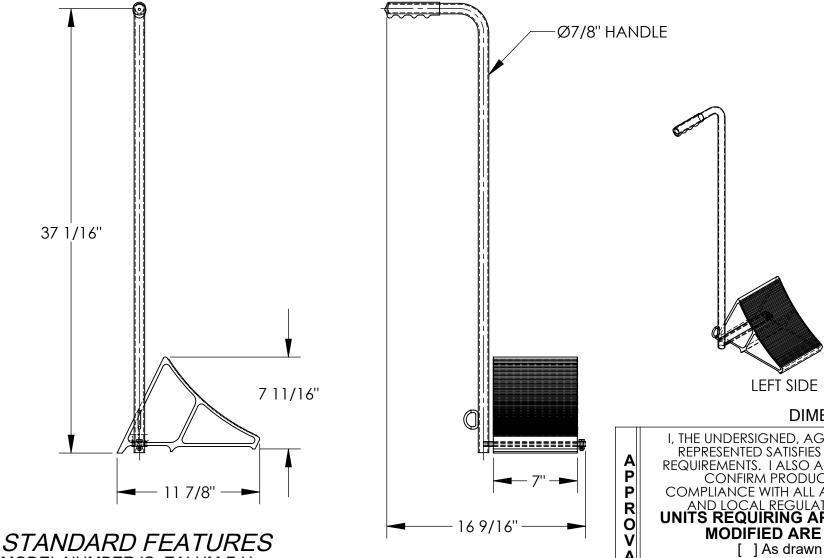
MODEL NUMBER IS: EALUM-7-H **OVERALL WIDTH IS: 17 1/16" CHOCK WIDTH IS: 7" OVERALL LENGTH IS: 11 7/8"** CHOCK LENGTH IS: 11 7/8" **OVERALL HEIGHT IS: 37 9/16"** CHOCK HEIGHT IS: 7 11/16" SHIPS KNOCKED DOWN HANDLE IS REVERSIBLE HANDLE IS TOUGH BAKED IN
